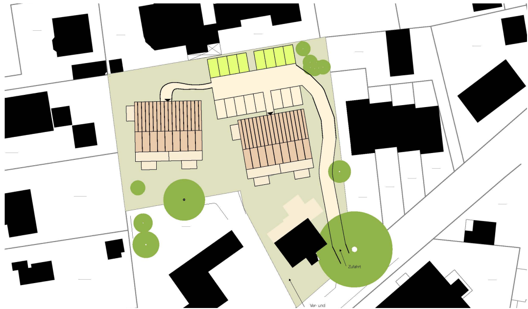
Abbildung 2: Lageplan Bauvorhaben Flurstück 42/8. Die Erschließung der Baukörper wird im Hinblick auf den Erhalt der Eiche im Verfahren zu prüfen sein. (Quelle: Architekt Heiko Schütt)
