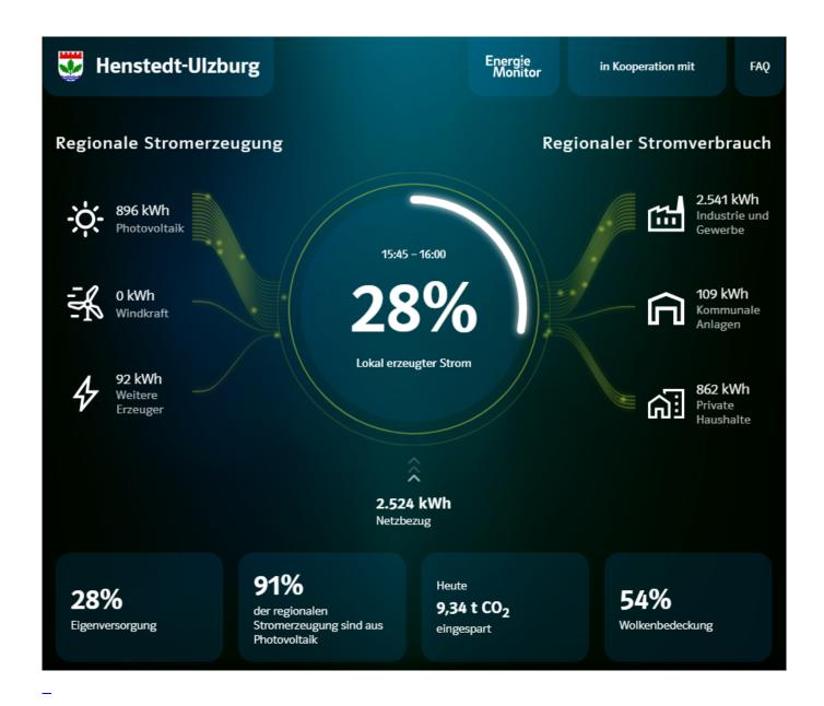
Der EnergieMonitor veranschaulicht die aktuelle Energiesituation in Henstedt-Ulzburg: Er stellt die lokale Stromerzeugung z.B. aus Photovoltaik, Windkraft oder Biomasse dem örtlichen Stromverbrauch gegenüber. Er zeigt den Grad der Eigenversorgung und wann Strom aus dem Netz bezogen oder ins Netz eingespeist wird. So macht der EnergieMonitor den Stand der Energiewende auf lokaler Ebene sichtbar. Zum Energiemonitor Henstedt-Ulzburg
